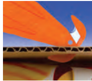
CURVO Più superficie di taglio crea tagli più morbidi, più facili e riduce l'accumulo di materiale.
